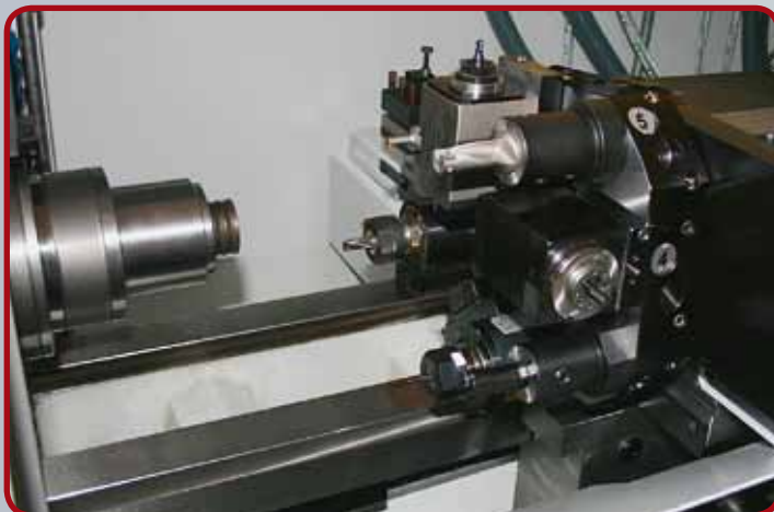
Aires de travail – Revolver outils fixes et tournants • Arbeitsbereiche – Revolver mit festen und angetriebenen Werkzeugen Working areas – Rotating turret with fixed and driven tools
