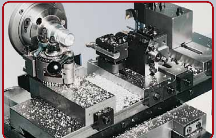
Aires de travail – Système d'outils linéaires • Arbeitsbereiche – Linear Werkzeugsystem • Working areas – Linear tools system
